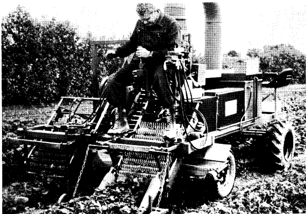
Fig. 1. Prototype af jordbærhøster fremstillet ved Værkstedet for Udvikling af Forsøgsteknisk Udstyr, Årslev.
