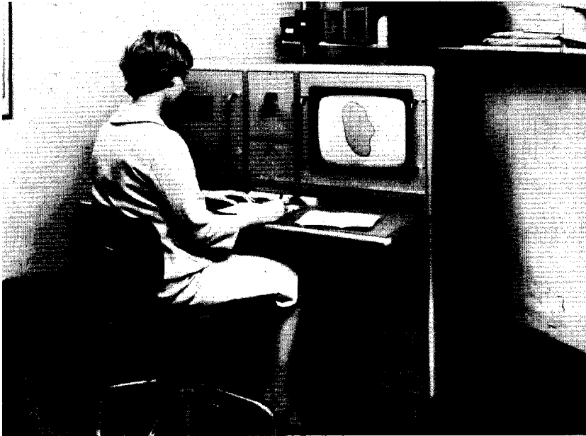
Figur 2. Elektronisk planimeter til måling af kød- og spækarealer.
