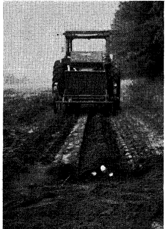
Fig. 1. Placering af gødning i 2 strenge 5-6 cm til siden for og 4-5 cm dybere end læggeknoldene. Fertilizer placed in bands 5-6 cm beside and 4-5 cm below the seed.
