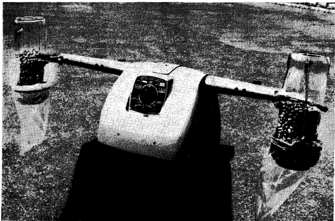
Fig. 1. Griffin Flask Shaker anvendt til rystning af bejdsset frø for undersøgelse af bejdsmidlernes vedhæftningsevne. Fot. J. B.
