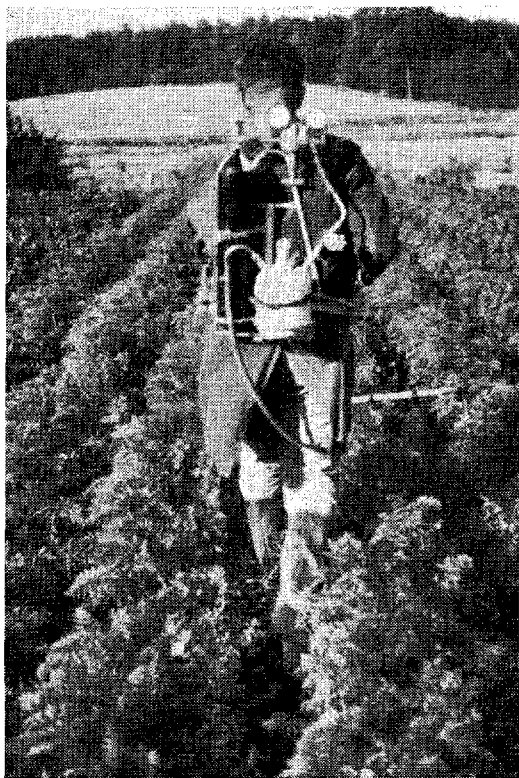
Fig. 6. Sprøjtning af gulerodsflueforsøg med »tryklufsprøjte« og »sprøjtebom« der kan bæres og betjenes af een mand, se også fig. 7.
