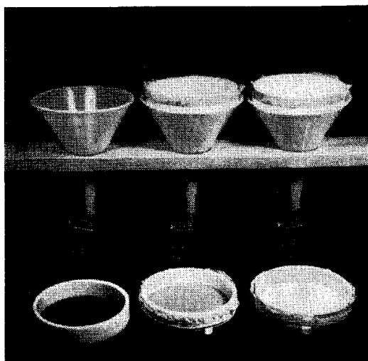
Fig. 2. Opstilling af de anvendte kombinationer af filtre og trage til ekstraktion af nematoder fra jord efter henholdsvis Oostenbrinks »Cottonwool filter method« (øverst) og Seinhorsts »Elutriator method« (nederst). I nederste række ses (fra venstre): 1) Polyvinylchlorid - (PVC) ring (udvendig diameter 12,5 cm, højde 2,5 cm), 2) PVC ring med påmonteret nylonvæv og støtteben, 3) samme med nematodfilter anbragt i petriskål.
