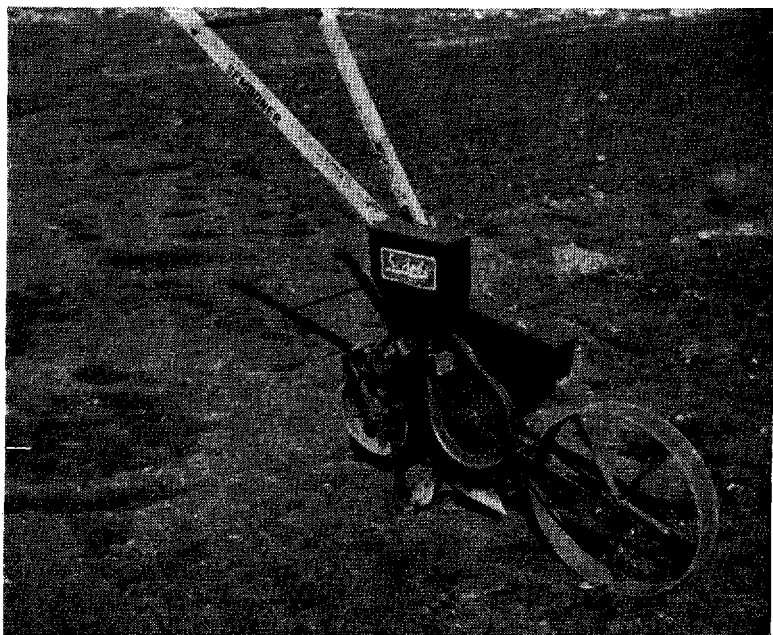
Fig. 2. Håndsåmaskine til samtidig såning af større mængder frø og granulat; granulat øverste såkasse. Foto: E. Nøddegaard.
