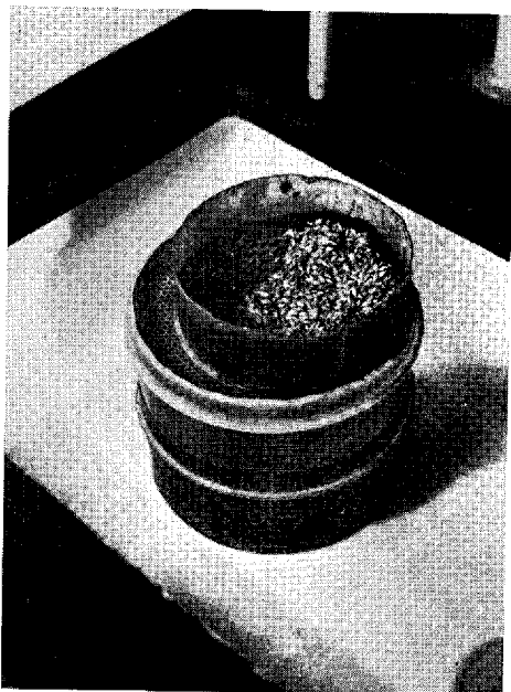
Fig. 1. System af sigter. (Succession of screens).
