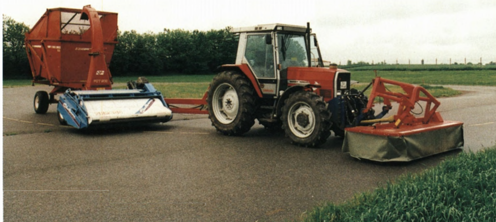
Figur 1. Ribbehøsteren består af et 2,4 m ribbebord, monteret på en bugseret JF-fin-snitter. The stripper header consists of a 2.4 m grain stripper header mounted on a towed JF-forage harvester. Photo: J. Vinther
