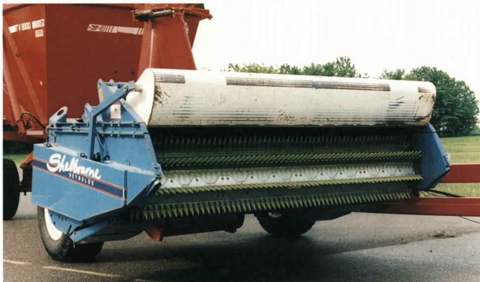
Figur 2. Ribbehøsteren set forfra, hvor rotoren med plastfingrene ses. Front view of the stripping header showing the rotor with plastic grippers. Photo: J. Vinther
