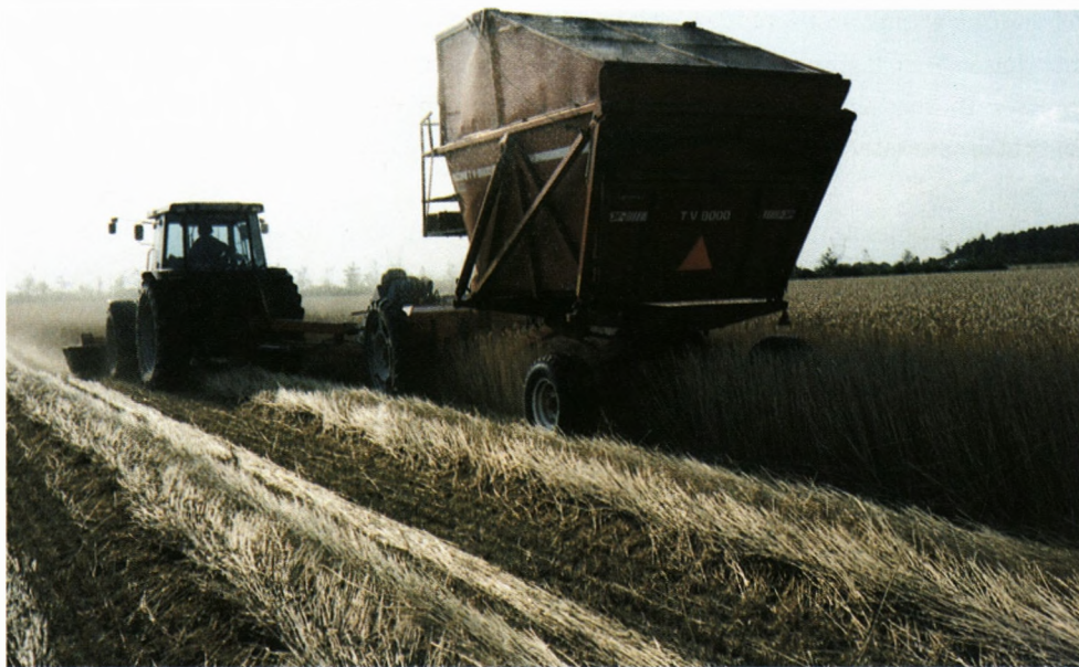
Figur 5. Ribbehøsteren i arbejde i tritcale under samtidig skårlægning af afribbede strå fra foregående skår. Grain stripper working in tritcale while mowing the stripped straw from the previous run
