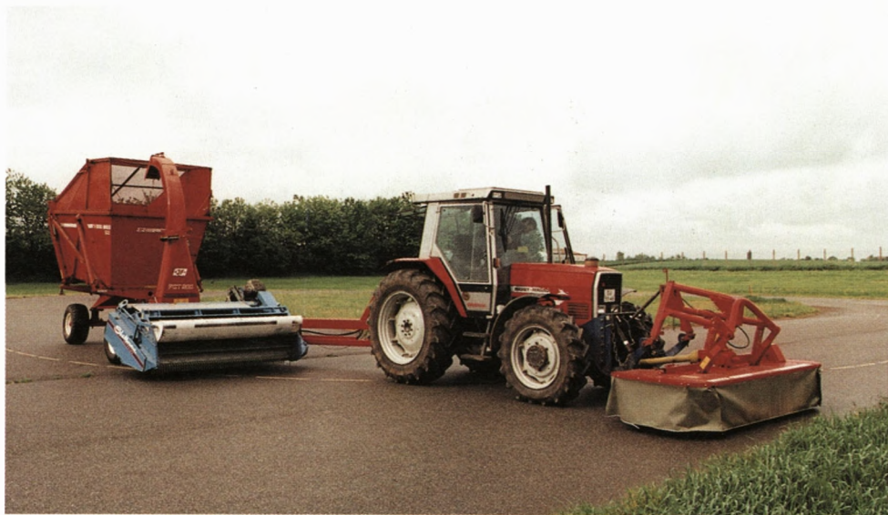
Figur 3. Bugseret ribbehøstsystem med frontmonteret skårlægger. Towed stripper harvesting system with front-mounted mower
