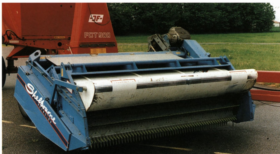
Figur 4. Ribbebordets ribbetromle med plastfingre, til afrivning af aks og korn. Stripper rotor with plastic fingers for stripping off ears and grain
