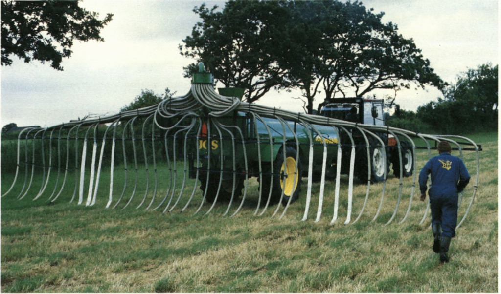
Gyllevogn med slæbeslangeudstyr. Udbringning af gylle med slæbeslangeudstyr i voksende afgrøder reducerer tabet af kvælstof ved ammoniakfordampning. (Foto: Jens Petersen).
