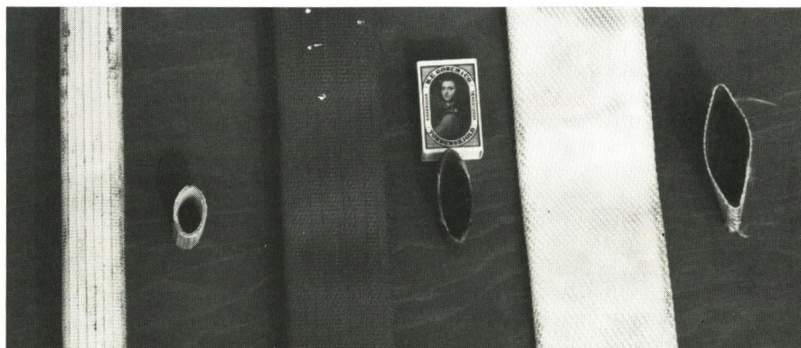
Figur 8. I de peristaltiske pumper benyttes flade slanger af mærket Triapres (t.v. 19 mm Ø og i midten 38 mm Ø). Almindelig brandslange (t.h.) er ikke tilstrækkelig slidstærk. The hoses (Triapres) in the peristaltic pumps are 19 mm Ø (left) or 38 mm Ø (middle). Firehoses do not wear well (right).
