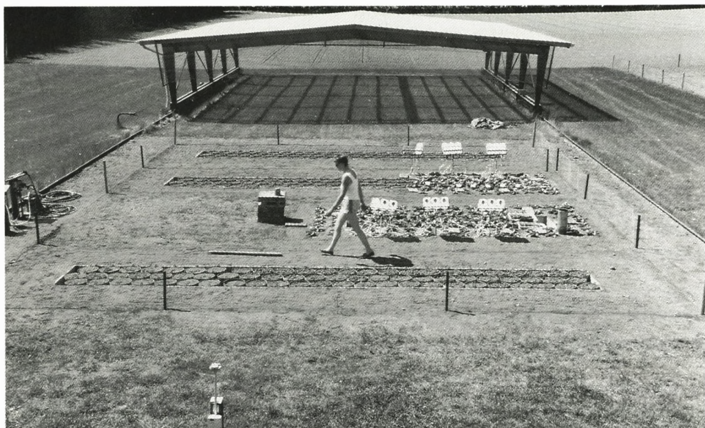
Fig. 1. Oversigt over karforsøgsanlægget. I forgrunden ses føleren, der ved nedbør aktiverer taget.
