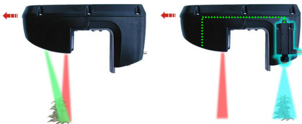
Figur 2. WeedSeeker konceptet. En infrarød lyskilde (rød) belyser jordoverfladen i bånd på 30 cm. En optisk sensor detekterer reflekteret infrarødt lys fra grønt plantemateriale og med en forsinkelse tilpasset fremdriftshastigheden aktiveres sprøjtedysen ( www.greenseeker.com ). The WeedSeeker concept. An infrared beam illuminates the soil surface in 30 cm bands. An optical sensor detects the reflected infrared light from green plant tissue and activates the spraying with a delay adjusted to the forward speed.
