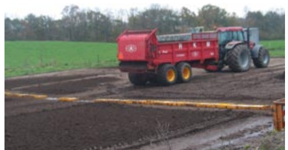
Fordelingen på tværs af kørselsretningen bestemmes ved opsamling af materialet i bakker stillet på tværs af kørselsretningen
