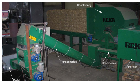
Figur 1. Forsøgsanlægget på Forskningscenter Bygholm, Institut for Jordbrugsteknik, blev anvendt til undersøgelsen med samfyring af gyllefibre og halm
