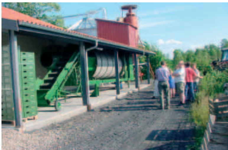
Foto 6. På billedet ses en tromletørrer, der bl.a. bruges til tørring af frisk høstet timian til brug i naturlægemidler og/eller fødevarer. Foto: Søs Kylling
