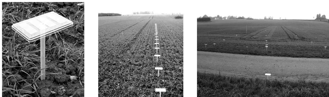
Figur 1. Venstre: Passiv dosimeter til opsamling af sprøjtevæske. Midt: Opsamlere inde i marken til måling af fordampning. Højre: Opsamlere til måling af afdrift uden for det sprøjtede areal.
