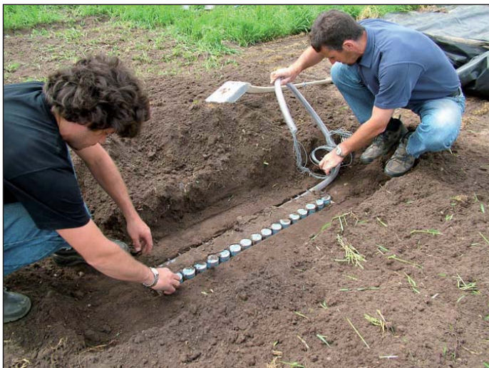
Foto 4. Placering af transducersystemet forud for måling. Se også Foto 8 (side 26).
