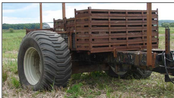
Foto 10. Testvognen i marken. Her med Nokian 800/50R34 og belastet svarende til ~60 kN.
