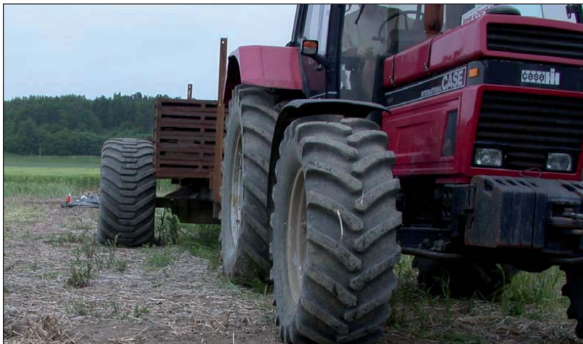
Foto 5. Specialfremstillet vogn med sideforskudt testhjul. Her påmonteret Nokian ELS 800/50R34 dækket. Hjullasten blev reguleret ved at lægge et forskelligt antal belastningslodder á ~500 kg på vognen. Begge vognens hjul var monteret med samme type dæk under testet. Se også Foto 10 (side 59).
