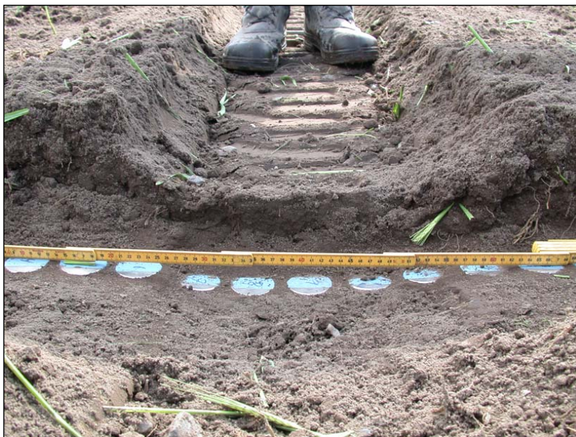
Foto 7. Jordoverfladen og transducersystemet efter test med Euroband dækket. Bemærk transducerhusenes store evne til at bevæge sig uafhængigt af hinanden. Se også Foto 12 (side 71). The uncovered transducer battery following a test with the Euroband tyre. Notice the high individual flexibility of the transducer housings. Also see Photo 12 (page 71).
