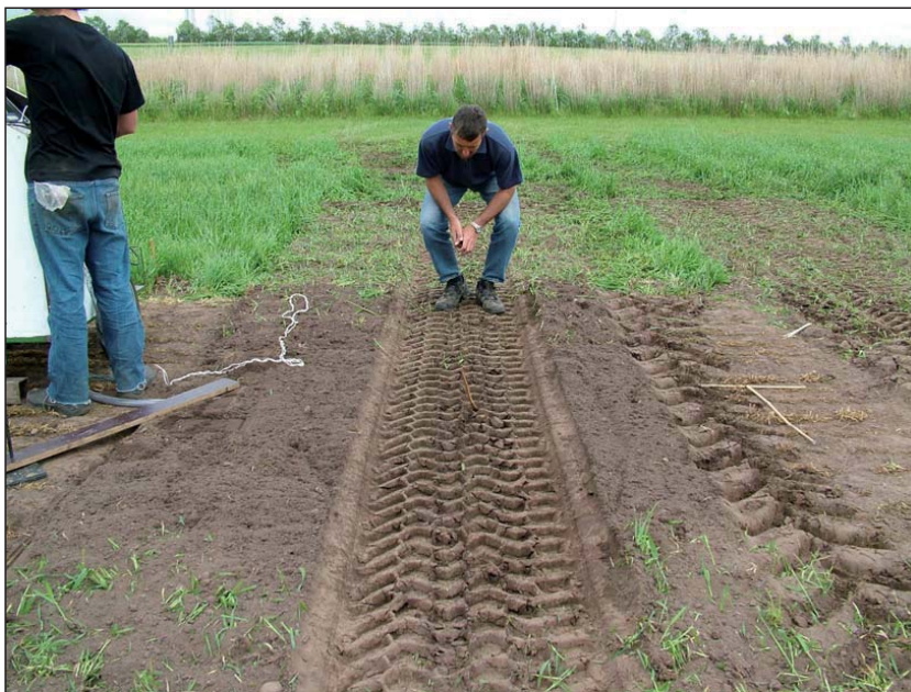
Foto 6. Jordoverfladen umiddelbart efter overkørsel med Michelin Cargo xbib dækket.
