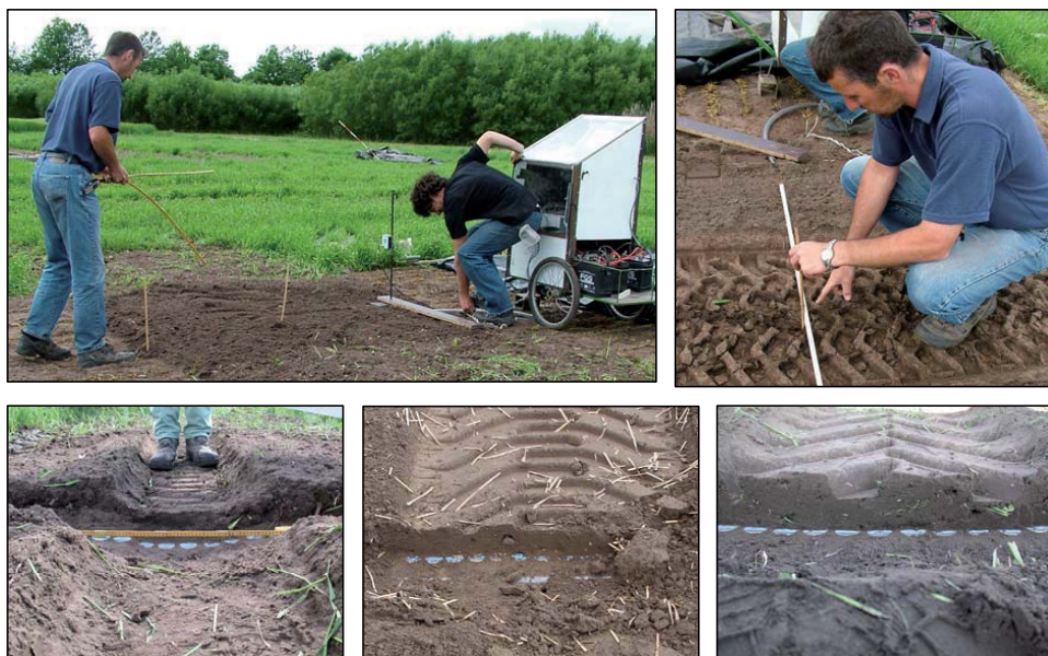
Foto 12. Øjebliksbilleder fra feltarbejdet (øverst; f.eks. trækvogn med dataopsamlingsudstyr), samt udvalgte spor efter testhjulet (nederst) ved ~60 kN hjullast og anbefalet dæktryk. Fra venstre mod højre ses Euroband, Nokian 800 samt Michelin Xeobib. Billedet af Nokian sporet stammer fra en lerjord, mens de to øvrige er fra testarealet med alle de øvrige test.
