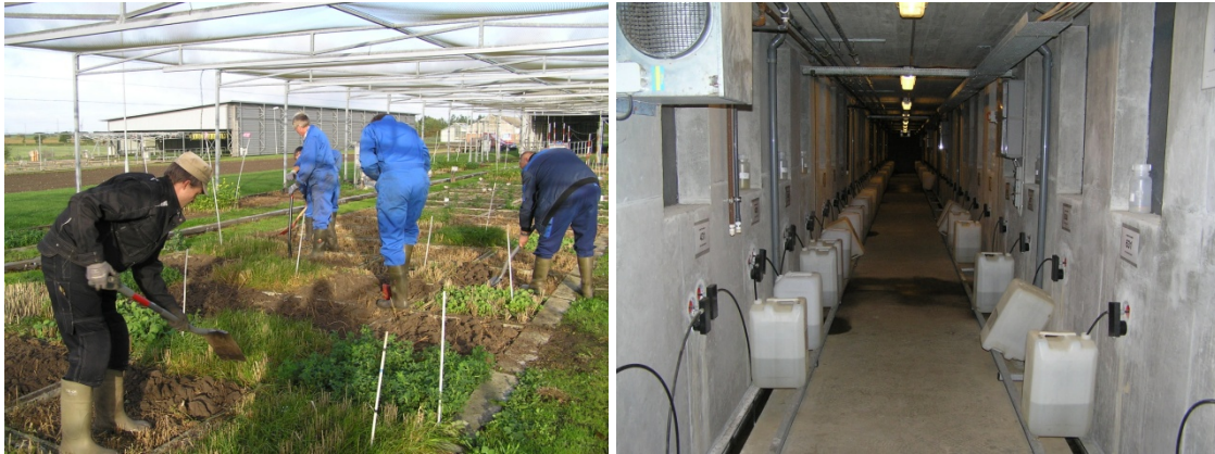
Figur 2. Jordbearbejdning og øvrige dyrkningsopgaver foregår manuelt i lysimetret. Hvert kar har et overfladeareal på 1x1 m og er 1.5 m dybe. Vand, der strømmer ud i bunden af karrene, opsamles i dunke placeret i en underjordisk gang. Foto: Ingrid K. Thomsen, Aarhus Universitet.
