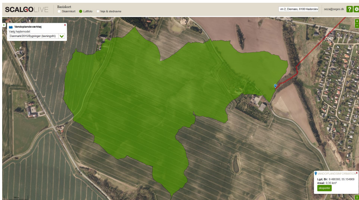
Figur 5. Oplandet der bidrager til drænafstrømningen i det pletdrænedede areal fra figur 4 er afgrænset i SCALGO til 35 ha. Størrelsen af det effektive drænoiland er sat til 15 ha (Kilde: SEGES).
