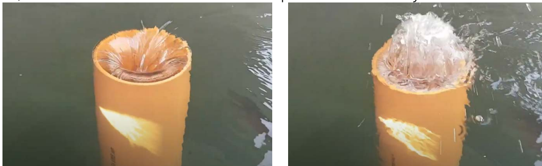
Figur 33. Indløbsrør ved AU's anlæg ved Slagelse, før det blev sat 10° på skrå. Billedet til højre viser, at vand trykkes ud af røret pga. af indespærret luft (Kilde: AGRO, AU).
