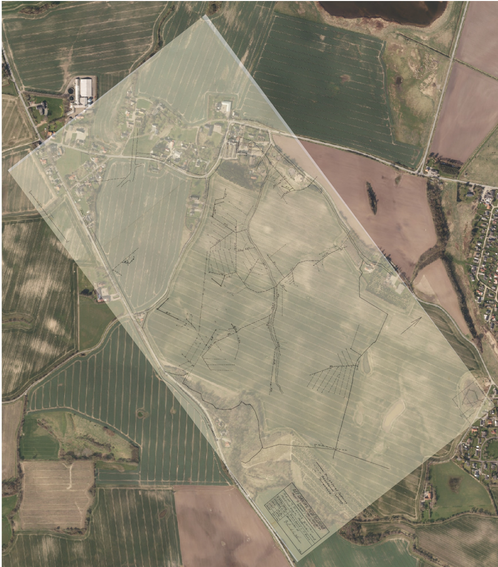
Figur 4. Pletdrænet areal i Sønderjylland hvor oplandet, der bidrager til drænafstrømningen er afgrænset i SCALGO, se figur 5 (Kilde: SEGES).
