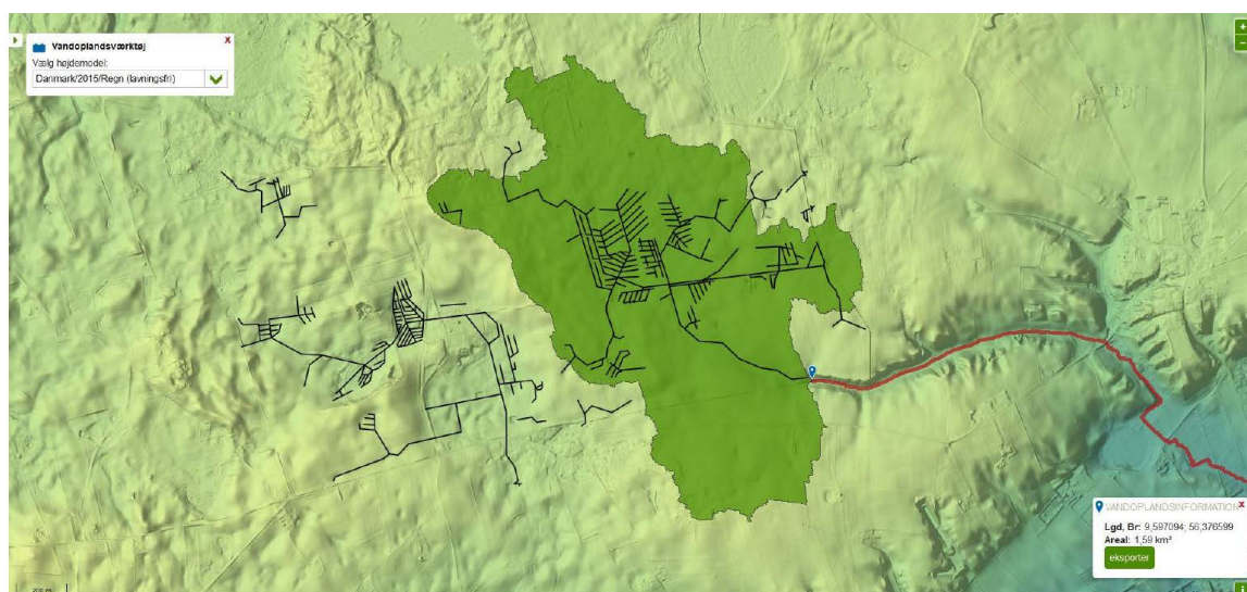
Figur 3. Drænoplandet for pletdrænet areal i Midtjylland (se figur 2) er fastlagt til 159 ha på baggrund af en terrænmodel i SCALGO (Analyse foretaget af SEGES). Størrelsen af det effektive drænopland er sat til 80 ha (Kilde: SEGES).
