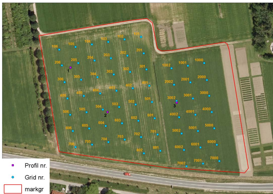
Figur 2. Gridnet med gridpunkter for forsøgsmarken i Årslev. Firkanterne viser placeringen af profilhuller, hvor der blev udtaget jordprøver til specialanalyser. Nord er opad på kortet.
