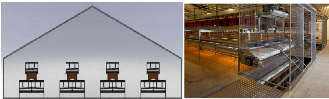
Figur 8.27. Tv.: Eksempel på konsumægstald med gulvdrift og etagesystem med gødningsbånd. Th.: Foto visende etagesystem med gødningsbånd, som afleverer fjerkrægødningen for enden af systemet i en tværkanal, der transporterer gødningen ud af stalden (Kilde: SEGES).
