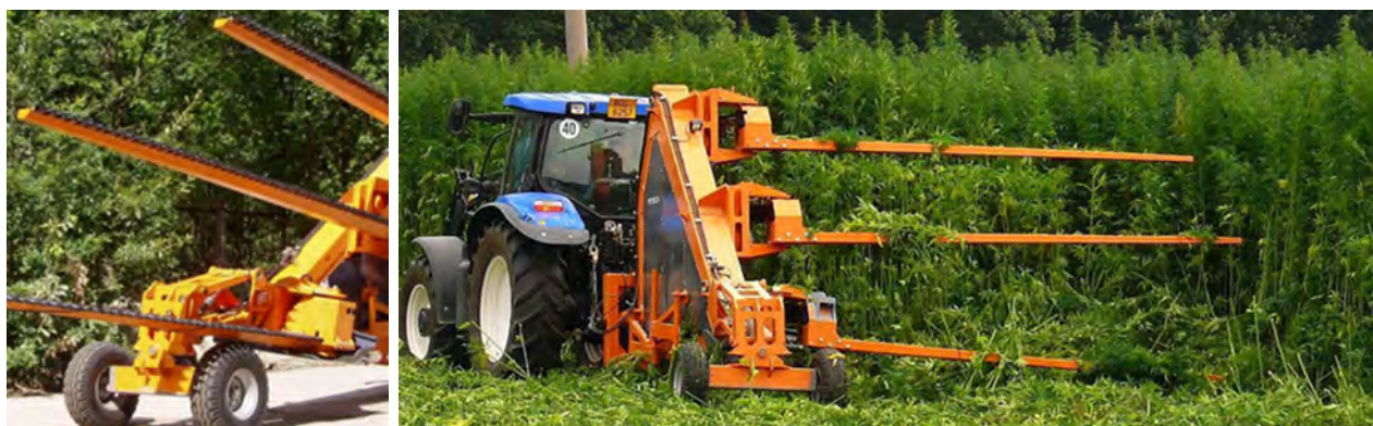
Figur 21. Tebeco Clipper 4.3 MMH høster med 3 knivbjælker. Foto: Ref. Luigi Pari et al., 2014
