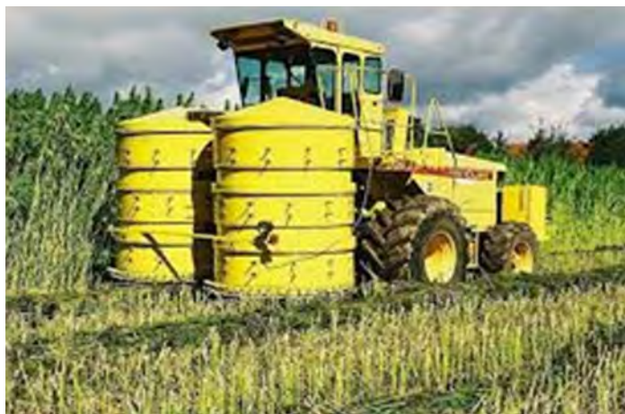
Figur 20. Bluecher 02 monteret på selvkørende New Holland 1905. Foto: Ref. Luigi Pari et al., 2014
