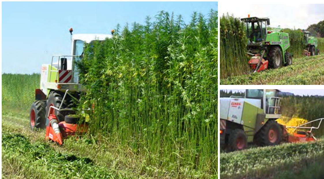
Figur 19. "HempCutter". Modificeret Kemper rækkeafhængigt skærebord monteret på selvkørende snitter. Foto: HempFlax Group B.V.
