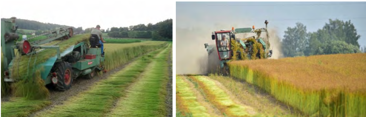
Figur 13. Maskiner til ruskning (høst) af fiberhør. Planten trækkes om med rod og aflægges i et velordnet skår på jorden. Foto: Swicofil/Swissflax
