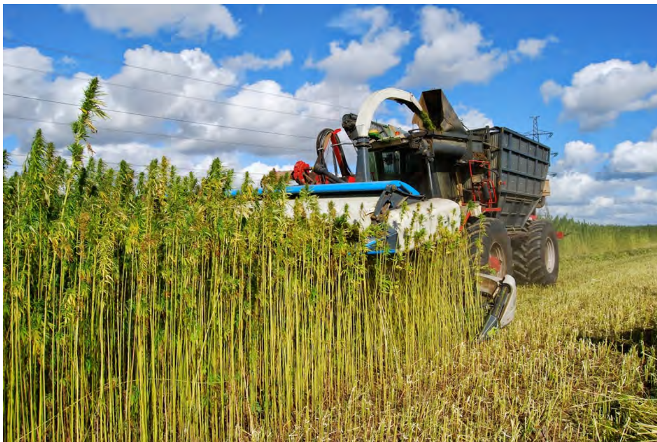
Figur 24. Hollandske Dun Agros hampehøster. Maskinen er bygget sammen af en selvkørende roeoptager, et majsskærebord, et ribbebord og en finsnitter. Foto Jens B. Kjeldsen, Aarhus Universitet
