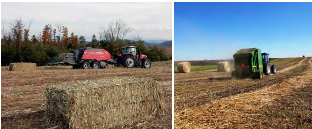
Figur 25. Presning af hamp med storballepresser. Foto: Reff. Luigi Pari et al., 2014
