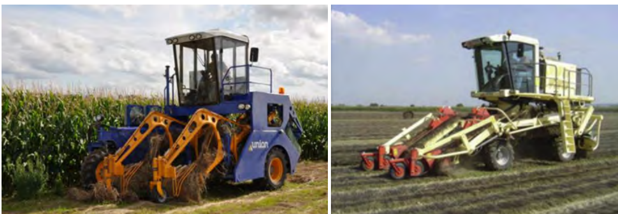
Figur 14. Selvkørende specialmaskine til vending af rusket hørskår. Foto: Reff. Luigi Pari et al., 2014
