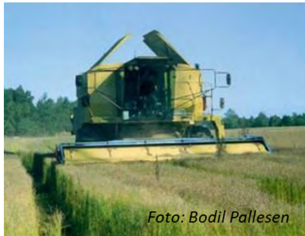
Figur 16. Høst af hørfrø med ribbebord monteret på mejetærsker. Foto: Bodil Pallesen, AgroTech
