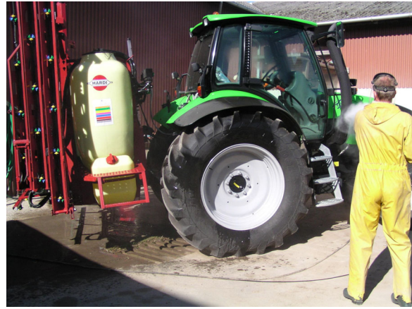
Billede 6. Til venstre ses rengøring i marken med højtryksrenser. Til højre ses rengøring over betonplads med opsamling af vaskevandet. To the left high pressure cleaning in the field, to the right cleaning over a concrete area with collection of the water.
