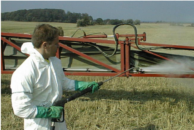
Billede 6. Til venstre ses rengøring i marken med højtryksrenser. Til højre ses rengøring over betonplads med opsamling af vaskevandet. To the left high pressure cleaning in the field, to the right cleaning over a concrete area with collection of the water.
