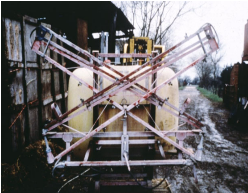
Billede 5. Ved udendørs opbevaring af sprøjten er der risiko for punktkildeforurening, hvis der parkeres samme sted hver gang. Outside storage of sprayers can be source to point contamination.
