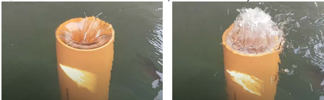
Figur 33. Indløbsrør ved AU's anlæg ved Slagelse, før det blev sat 10° på skrå. Billedet til højre viser, at vand trykkes ud af røret pga. af indespærret luft (Kilde: AGRO, AU).
